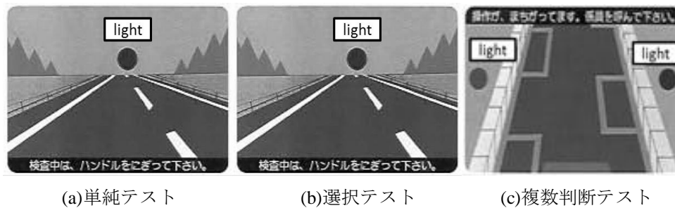
図17. ドライビングシミュレータでのテストの様子
