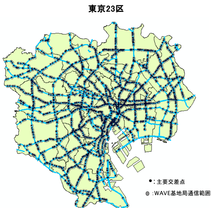
図 47 東京 23 区における主要交差点への RSE 設置イメージ
