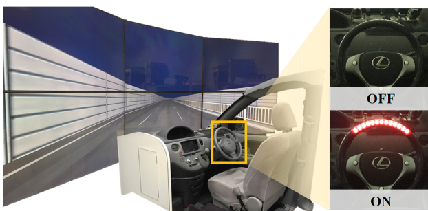
図2: 実験に用いる DS と LED 搭載ステアリング
