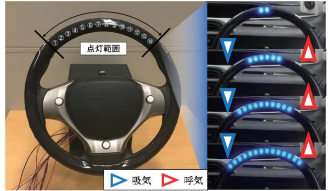
図 1 LED 搭載ハンドルの点灯パターン
