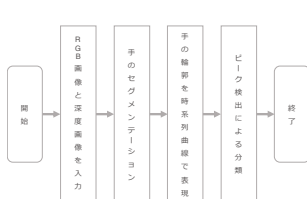
図1 ジャンケン認識システムの構成
