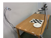
図2 カメラ間の距離 80cm の実験環境
