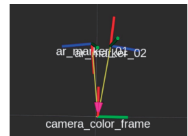
図6 2つのARマーカのフレームが出力されている例
